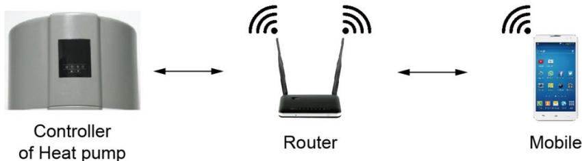
Encienda la unidad de bomba de calor y mantenga presionado el botón del temporizador y el botón de aumento al mismo tiempo durante 5 segundos. El icono SET 🔒 parpadeará. Cuando el indicador de Wi-Fi siga parpadeando rápidamente, haga clic en "Confirmar que el indicador parpadee rápidamente".
