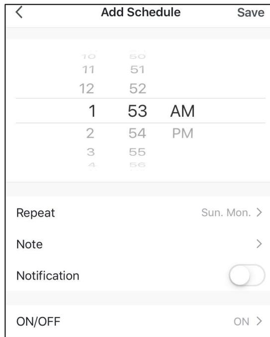
En esta interfaz, configure la hora y el día para que el temporizador se encienda y se apague. Después de la configuración, haga clic en "Guardar" para confirmar y guardar. La configuración del temporizador se mostrará en la siguiente interfaz. En esta interfaz, haga clic en "Agregar programa" para agregar otro temporizador de ON/OFF.
