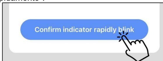
Notas: Cuando el icono del conjunto parpadea rápidamente, significa que el controlador está en modo Wi-Fi. Cuando parpadea lentamente, significa que el controlador se está conectando con la aplicación. Durante la conexión, si el icono del conjunto se apaga, significa que la conexión de la APLICACIÓN con la unidad ha finalizado.
