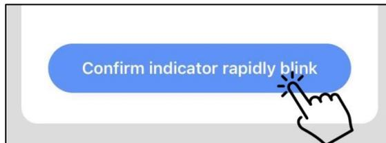
Notes: lorsque l'icône de réglage clignote rapidement, cela signifie que le contrôleur est en mode Wi-Fi. Lorsqu'il clignote lentement, cela signifie que le contrôleur se connecte à l'application. Pendant la connexion, si l'icône de réglage s'éteint, cela signifie que la connexion APP avec l'unité est terminée.
