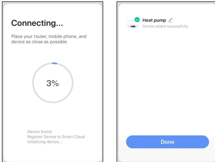
Nesta interface, o dispositivo (unidade de bomba de calor) pode ser nomeado como você quiser. Clique em "Concluído" para finalizar a instalação do aplicativo. A tela do dispositivo móvel exibirá a interface de controle do APP.
