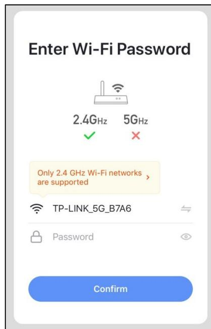
Após clicar em "Confirmar", o módulo Wi-Fi, o dispositivo móvel e o roteador Wi-Fi começam a se conectar. Encerre a conexão e a interface passará para a próxima interface.
